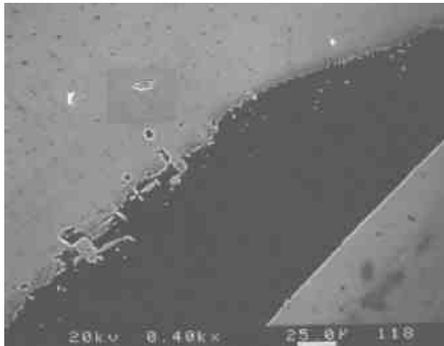
Edge pullback on OD area of part
